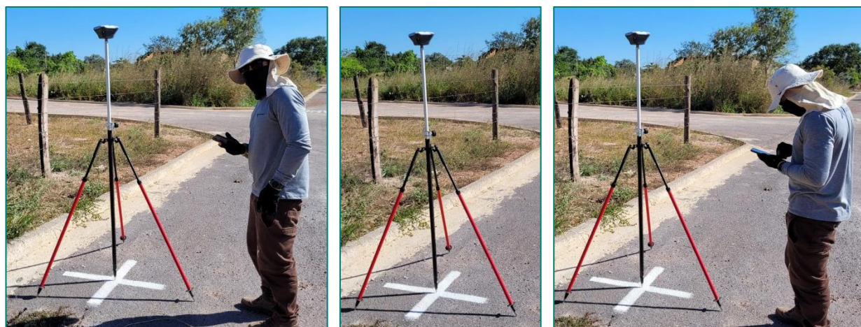
Figura 4. Esquema do georreferenciamento (pós-processamento) das coordenadas das imagens aéreas com o uso do sistema IBGE-PPP (Posicionamento por Ponto Preciso). Fonte: IBGE, 2019.
