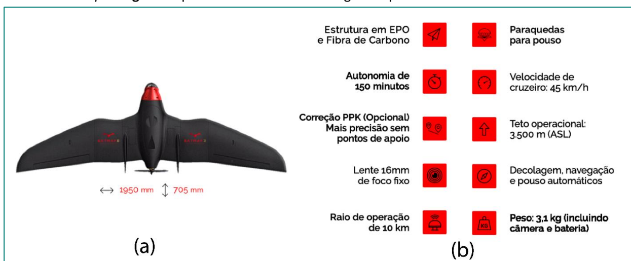
Figura 1. a) VANT Batmap II . b) Especificações técnicas.
